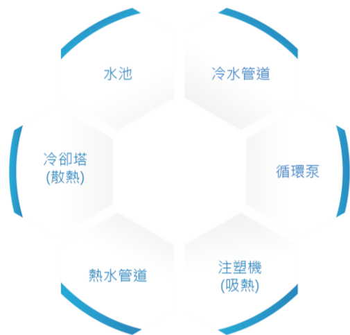
葳統科技冷卻水循環流程圖
